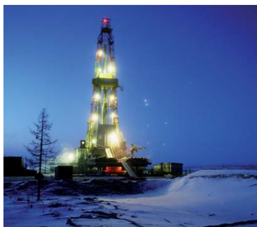
Bohranlage zum Abteufen von Produktionsbohrungen im westsibirischen Urengoi-Feld
